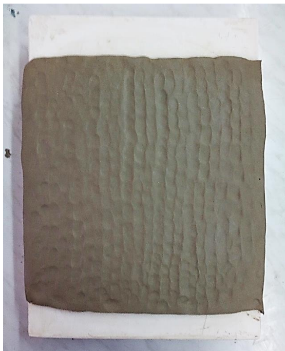
Obr. 7. Nanesená keramická hlína na sádrovém bloku s připraveným reliéfem.
