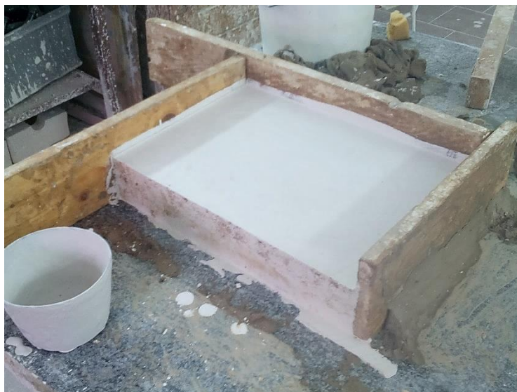
Obr. 5: Výroba sádrového bloku pro tvorbu následného reliéfu.
