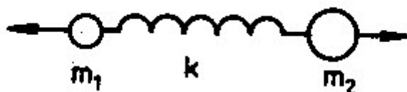
Obrázek 9: Pružinový model vibrace dvouatomové molekuly. [19]
