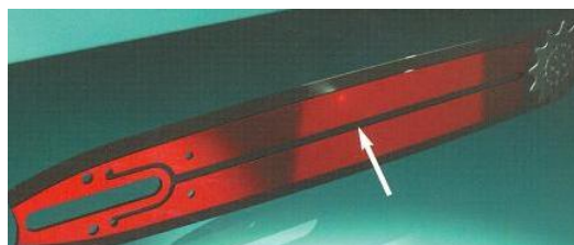
Obr. 22 Drážka na olej u lišt zkracovacích pil
