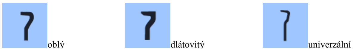
Obr. 16 Tvary zubů pilových řetězů
