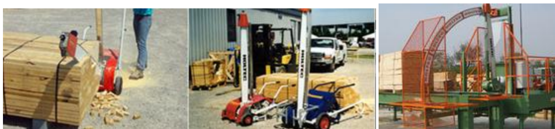
Obr. 30 Mobilní zkracovací pila Holtec a zkracovací pila pilařské linky.
