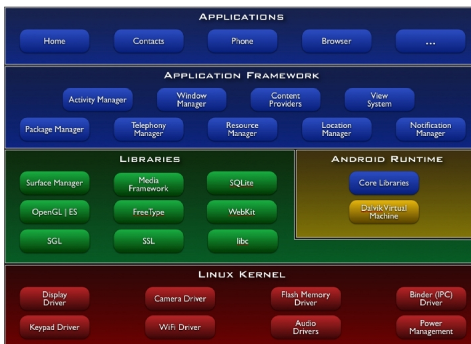
Obrázek 2.4: Architektura systému Android, obrázek byl převzat z [12].
