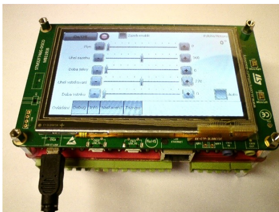
Obrázek 6.18: Řídicí panel s rozšiřující deskou
