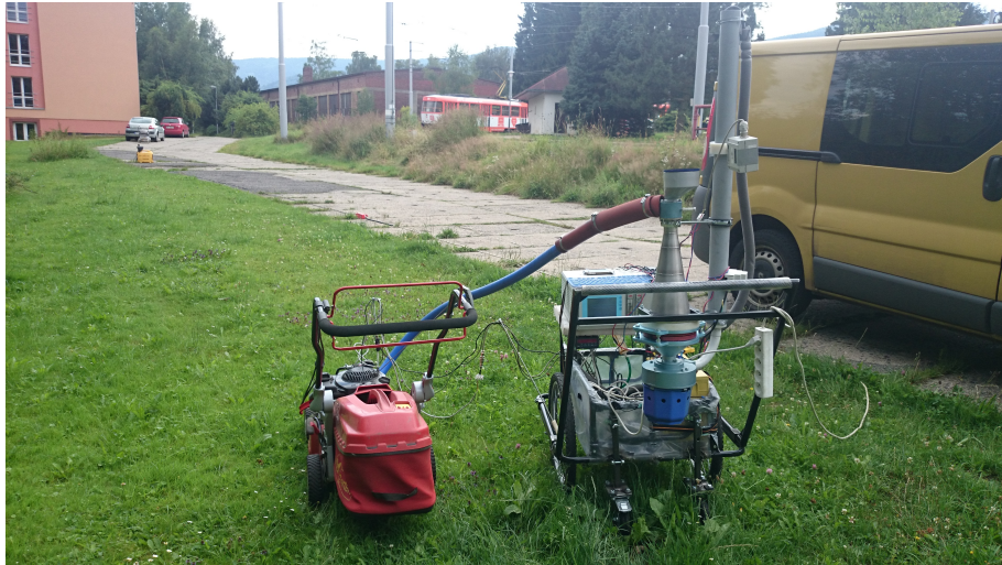
Obrázek 6.32: Schéma sestavy zařízení pro měření emisí
