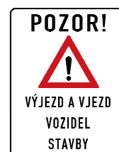
Obr. 7.8 Značení „Výjezd a vjezd vozidel stavby“
