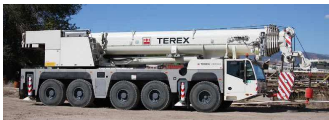
Obr. 4.1.1 Autojeřáb Terex Demag AC 200-1
