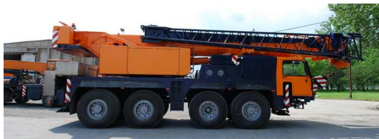
Obr. 4.1.5 Autojeřáb Liebherr LTM 1070/1
