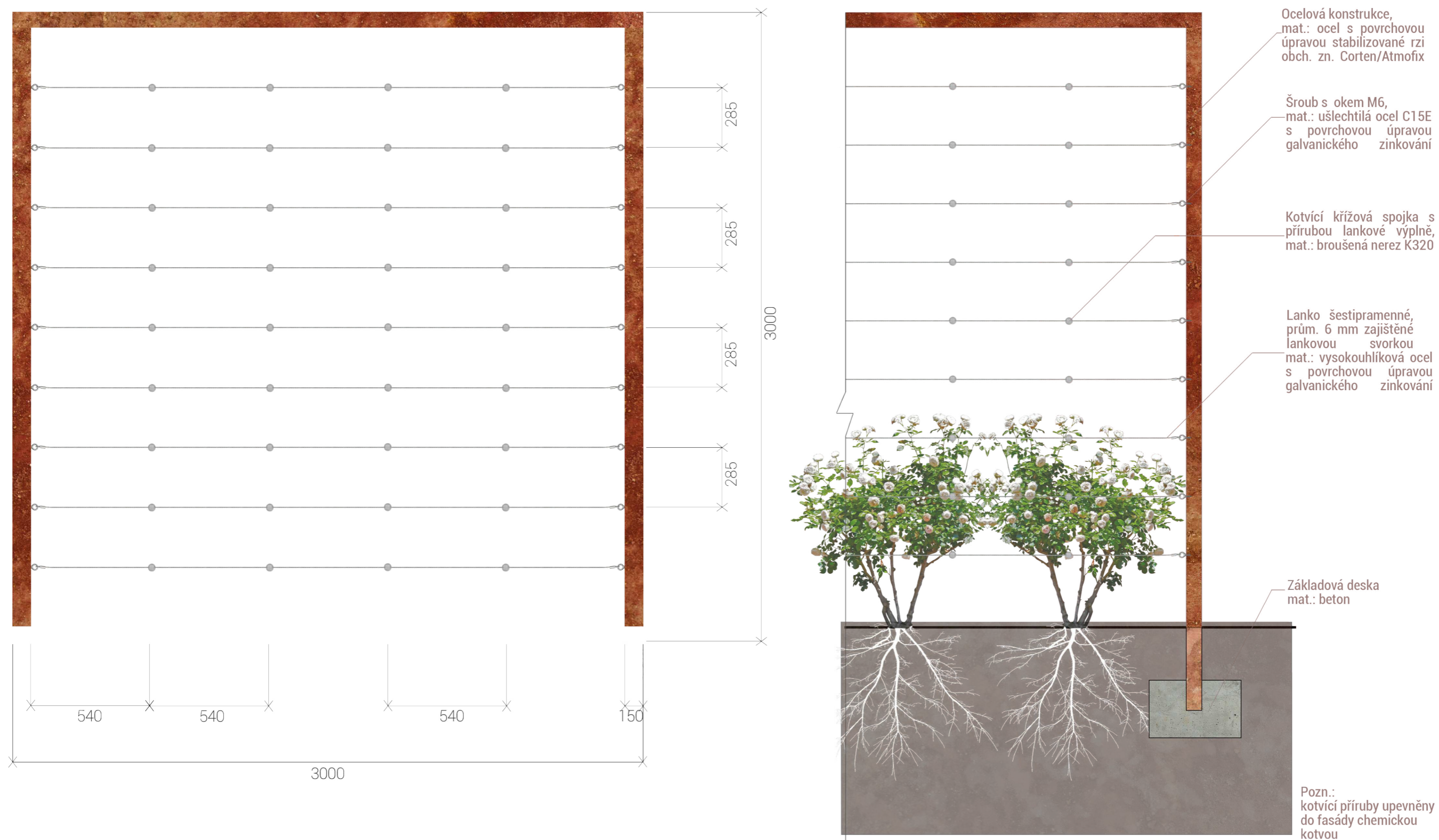
Obr 142. - Technická specifikace treláže u fasády Gryspekovského paláce (vlastní tvorba)
