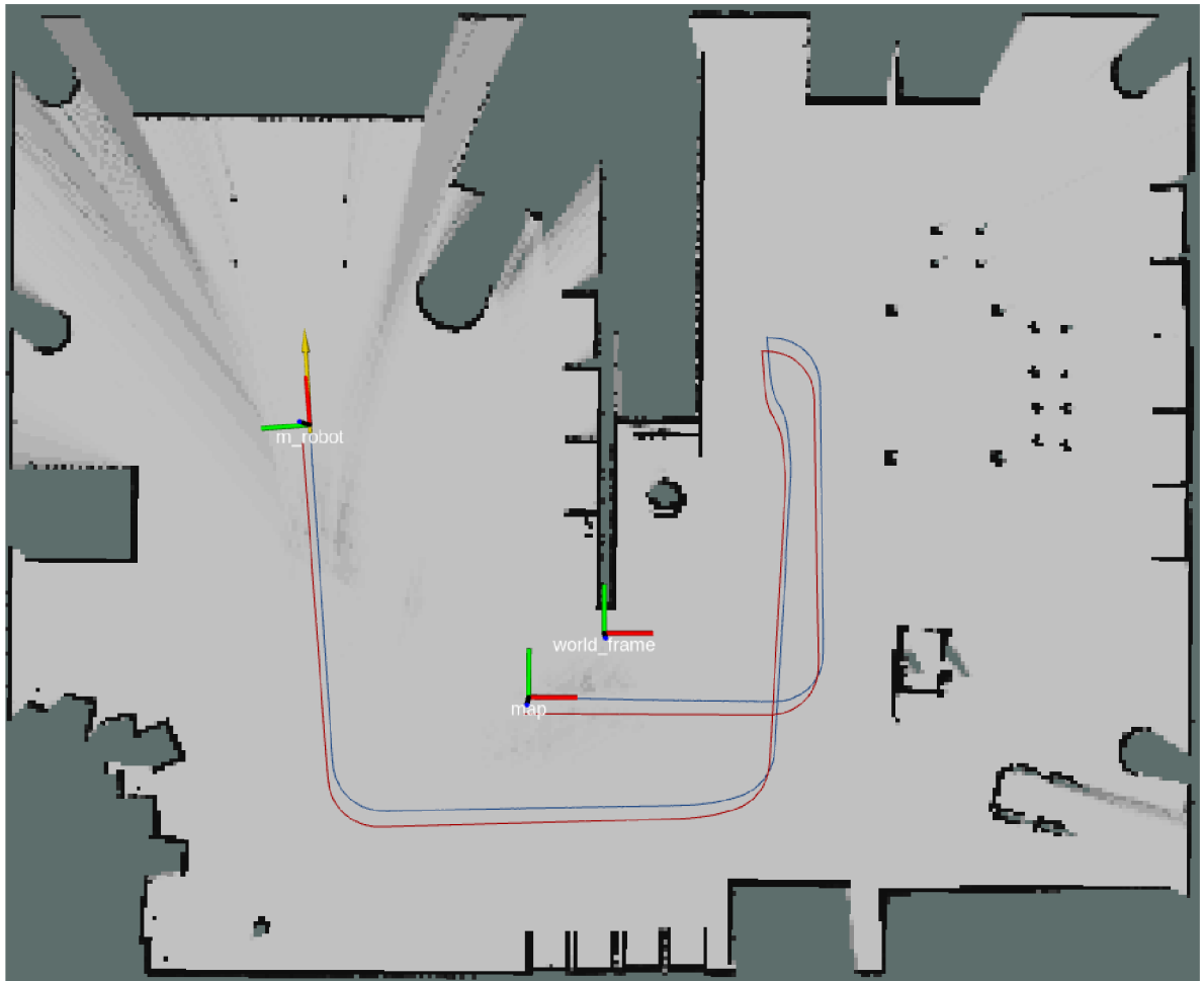
Obr. A.3: Mapa vzniklá pomocí Hector SLAM algoritmu
