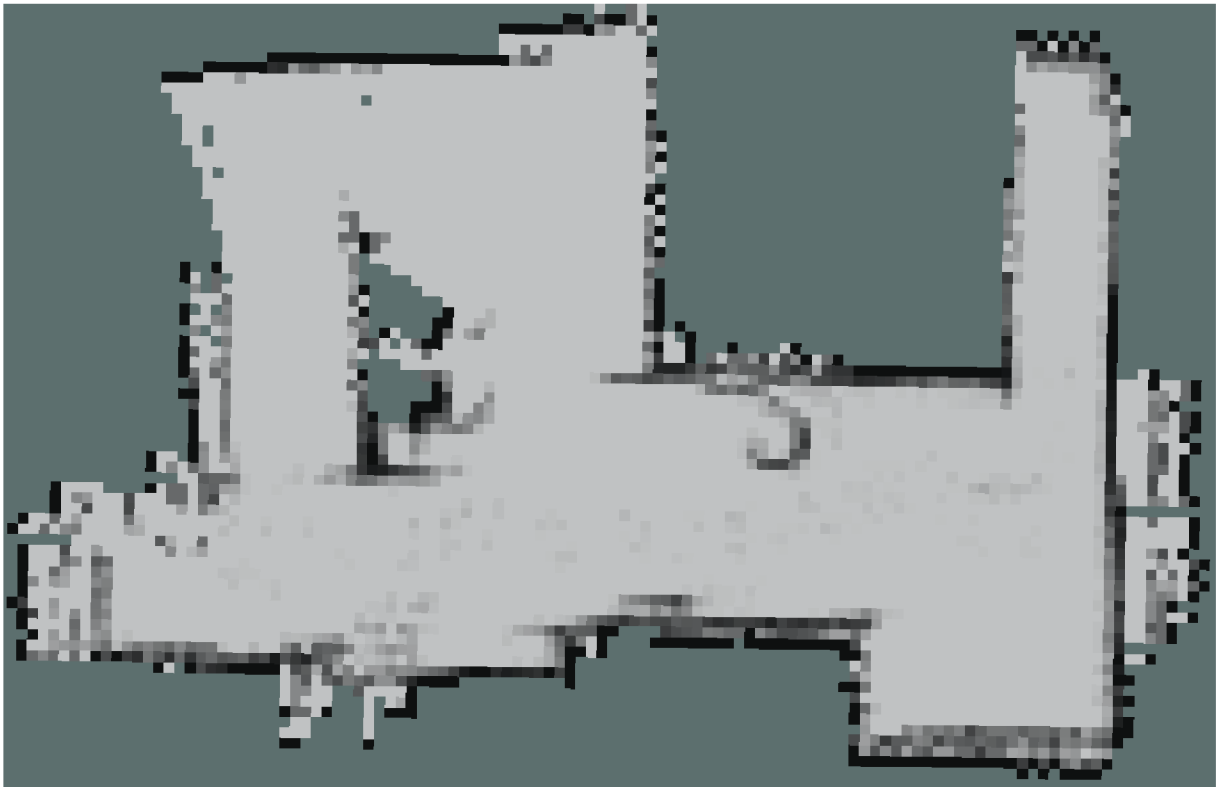
Obr. B.2: Mapa vzniklá pomocí Gmapping algoritmu v reálném světě
