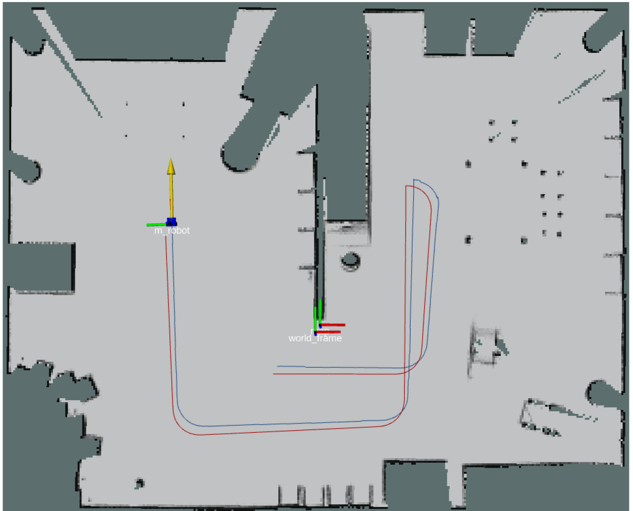
Obr. A.2: Mapa vzniklá pomocí Gmapping algoritmu
