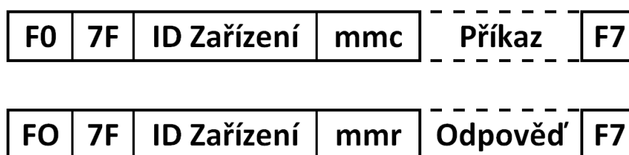
Obr. 1.5: Struktura dat protokolu MMC.
