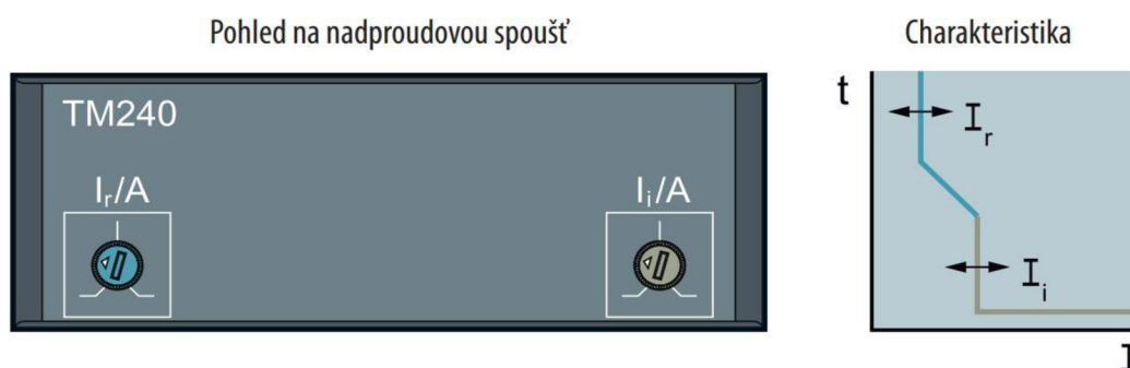
Obrázek 1.7 Pohled na nadproudovou spoušť (vlevo), charakteristika (vpravo) (převzato z [7])
