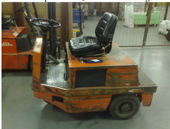
Obr. 7 dopravní vozík nosnost 500 kg
