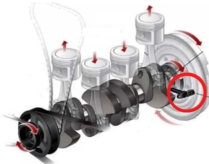
Obrázok 7 Umiestnenie snímača polohy kl'ukového hriadeľa [20]
