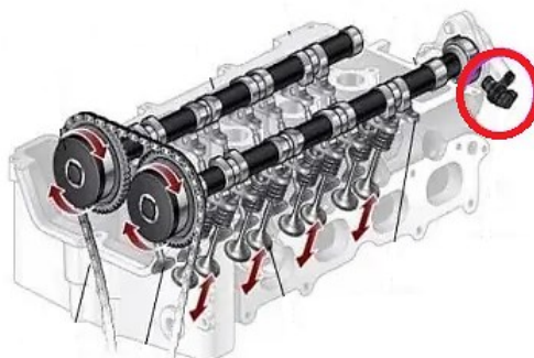
Obrázok 11 Umiestnenie snímača polohy vačkového hriadeľa [22]
