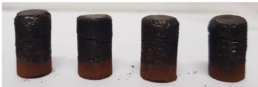
Obr. 2 Ukázka vyprodukovaných pelet popisovanou metodou
