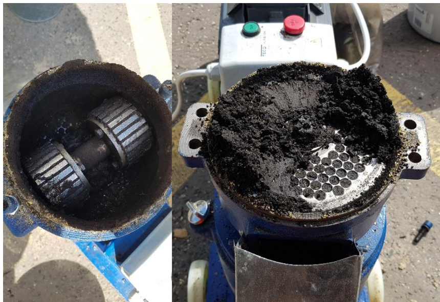
Obrázek 28 Ucpání malého peletovacího lisu
