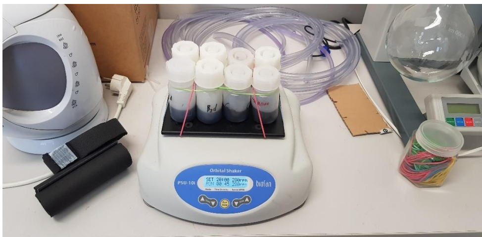
Obrázek 31 Průběh zkoušky rozpustnosti na orbitální třepačce
