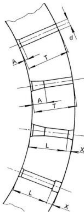
Obrázek 5 Ukázka druhů reliéfů matrice. Shora přímý, hluboký, kuželový, válcový (Jansa 2011)
