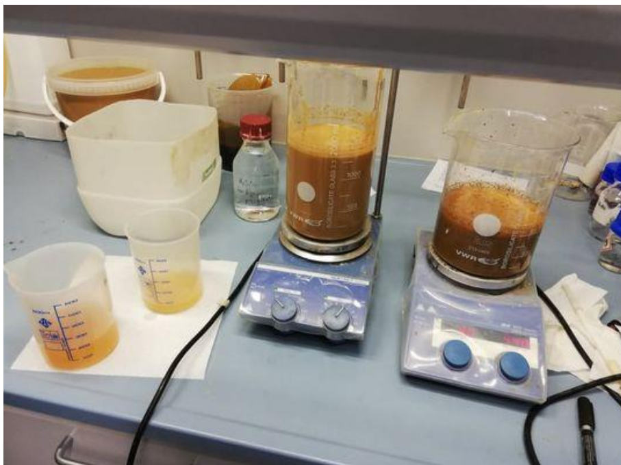
Obrázek 21 Průběh precipitace ligninu z černého louhu
