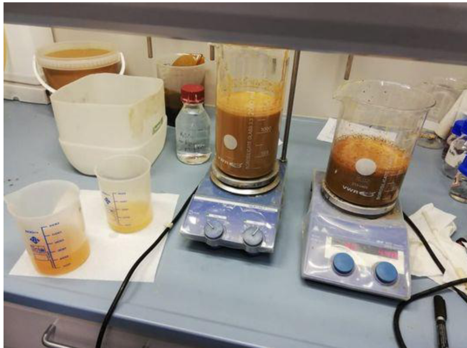
Obrázek 21 Průběh precipitace ligninu z černého louhu
