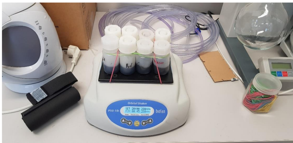
Obrázek 31 Průběh zkoušky rozpustnosti na orbitální třepačce
