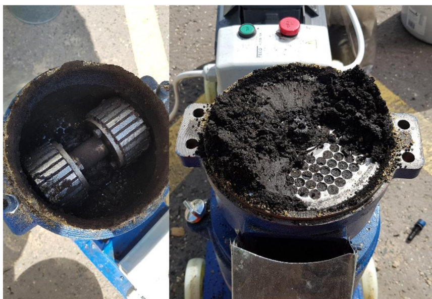
Obrázek 28 Ucpání malého peletovacího lisu
