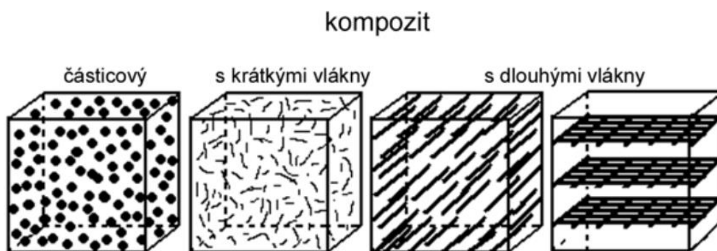
Obr. 4: Rozdělení kompozitních materiálů podle geometrického tvaru výztuže [1]
