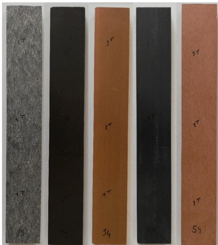
Obr. 24: Ukázka vzorků pro měření lesku, drsnosti a smáčivost
