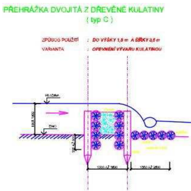
(Obr. č. 20., jednoduchá přehrážka z dřevěné kulatiny typu C, Revitalizace rašelinišť v Krušných horách, dílčí část Cínovecký hřbet – 1. etapa 2009)
