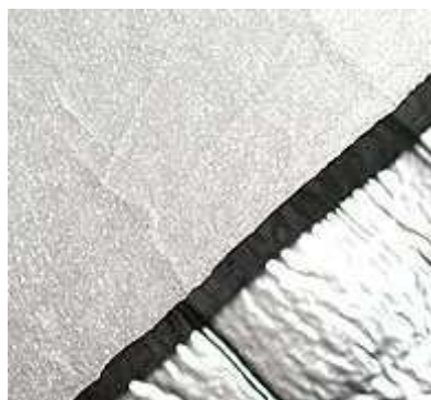
Obr. 63 – Detail souvrství vzorku č. 4
