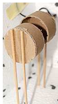
Obr. 42 – Kytí teplotního čidla
