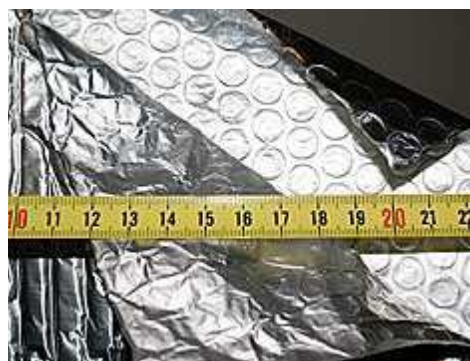
Obr. 61 – Detail souvrství vzorku č. 3
