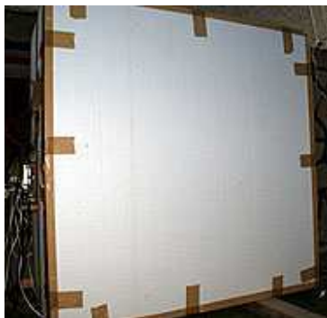
Obr. 54 – Vzhled referenčního vzorku připraveného do „teplé“ strany EPS krabice
