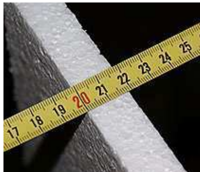
Obr. 55 – Detail referenčního vzorku při určení jeho tloušťky
