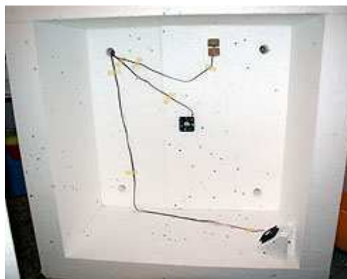
Obr. 36 – Studená EPS krabice s větracími otvory, ventilátorem pro homogenizaci prostředí a teplotním čidlem PT 1000
