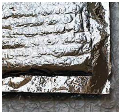
Obr. 23 -Termoreflexní souvrství s reflexní folií uprostřed
