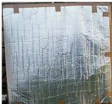
Obr. 66 – Vzorek č. 6 připravený na teplých EPS krabicích
