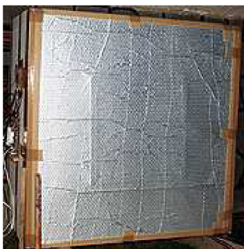
Obr. 58 – Vzorek č. 2 připravený na teplých EPS krabicích
