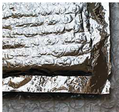
Obr. 23 -Termoreflexní souvrství s reflexní folií uprostřed
