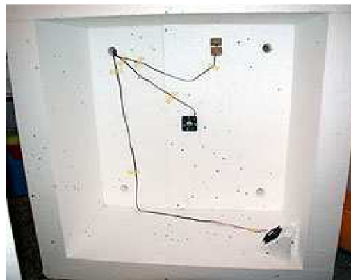
Obr. 36 – Studená EPS krabice s větracími otvory, ventilátorem pro homogenizaci prostředí a teplotním čidlem PT 1000
