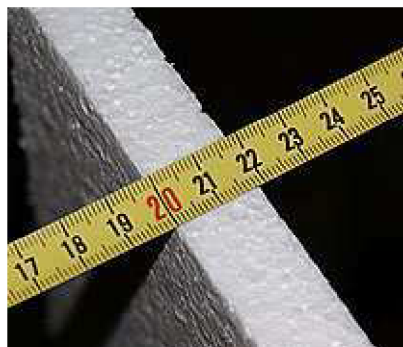
Obr. 55 – Detail referenčního vzorku při určení jeho tloušťky
