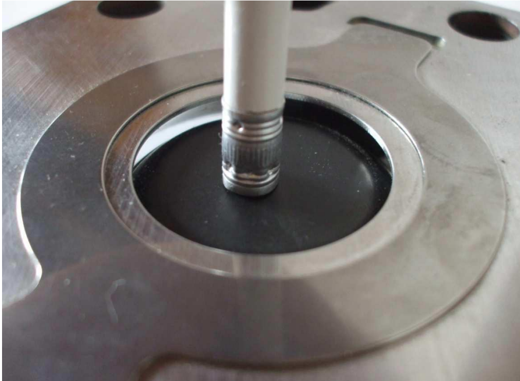
Obr. 41 Otvorený výtláčny ventil (ilustračný obrázok)
