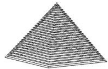
Výroba součásti po vrstvách
