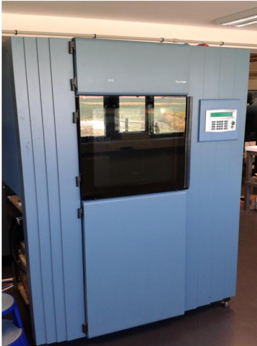
Obr. 20: Výrobní zařízení Fortus 400mc Large. (Zdroj: snímek v MCAE Systems, s.r.o.)
