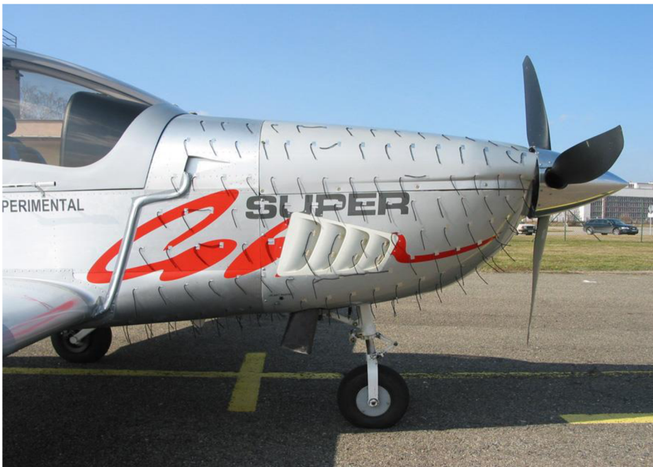
Obr. 27: Mřížka výstupu vzduchu vyrobená pomocí 3D tisku. (Zdroj: evektor.cz)
