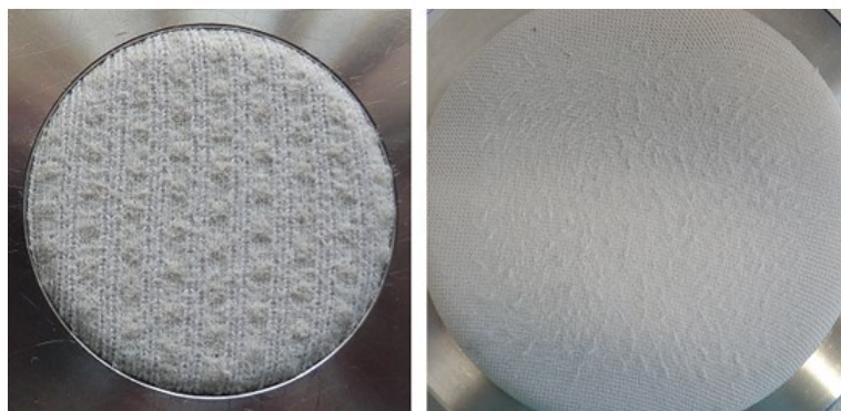
Obrázek 83: „Malý“ vzorek PA 6.6 vazba 1 a „velký“ vzorek PA 6.6 vazba 2 po 20000 otáčkách oděru
