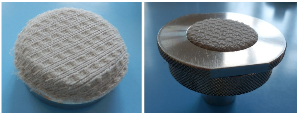
Obrázek 81: Vzorek PA 6.6 vazba 1 přilepený na vložku držáku a upnutý do držáku vzorků
