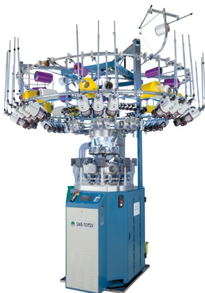
Obrázek 29: Elektronicky řízený středopřůměrový jednolůžkový pletací stroj od společnosti Santoni S.p.A. (typ SM8-TOP2V) [74]
