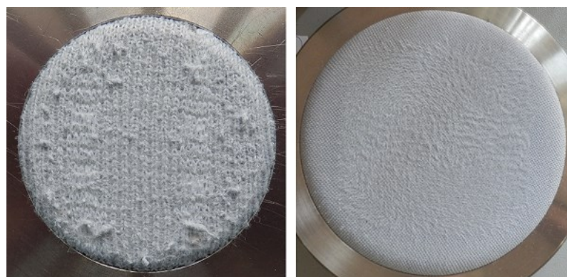
Obrázek 88: „Malý“ vzorek PES (CM) vazba 3 a „velký“ vzorek PES (CM) vazba 2 po 20000 otáčkách oděru
