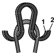
Obrázek 32: Vazba krytá – krytá a krycí nit [4]
