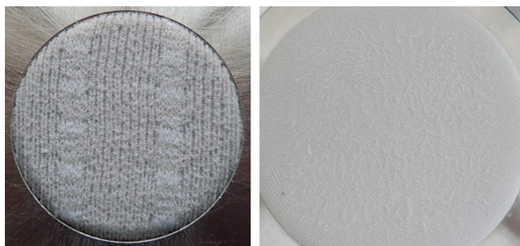
Obrázek 85: „Malý“ vzorek PA 6.6 vazba 3 a „velký“ vzorek PA 6.6 vazba 2 po 20000 otáčkách oděru
