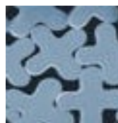
Obrázek 16: Tvar průřezu vláken COOLDRY ® [30]
