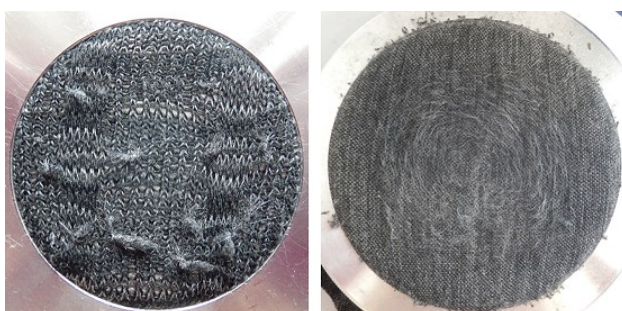
Obrázek 94: „Malý“ vzorek WO+PES vazba 3 a „velký“ vzorek WO+PES vazba 2 po 20000 otáčkách oděru
