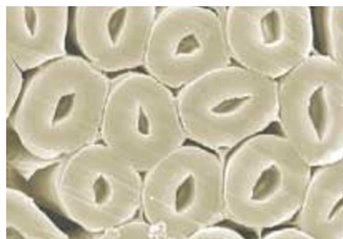
Obrázek 24: Průřez vlákný SUNLITE ® [47]
