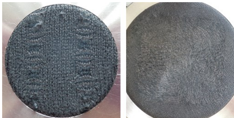
Obrázek 91: „Malý“ vzorek PES (TH) vazba 3 a „velký“ vzorek PES (TH) vazba 2 po 20000 otáčkách oděru
