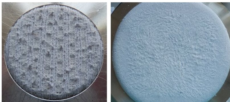
Obrázek 86: „Malý“ vzorek PES (CM) vazba 1 a „velký“ vzorek PES (CM) vazba 2 po 20000 otáčkách oděru
