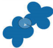
Obrázek 11: Tvar průřezu vláken COOLMAX® AIR [22]
