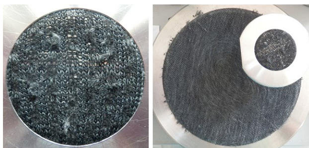
Obrázek 92: „Malý“ vzorek WO+PES vazba 1 a „velký“ vzorek WO+PES vazba 2 po 20000 otáčkách oděru
