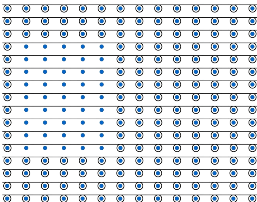
Obrázek 75: Střída vazby 3 zakreslená v anglickém systému patronování
