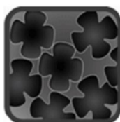
Obrázek 19: Tvar průřezu vláken AEROCOOL® [38]
