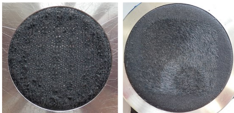
Obrázek 89: „Malý“ vzorek PES (TH) vazba 1 a „velký“ vzorek PES (TH) vazba 2 po 20000 otáčkách oděru
