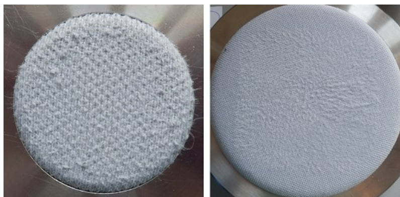
Obrázek 87: „Malý“ vzorek PES (CM) vazba 2 a „velký“ vzorek PES (CM) vazba 2 po 20000 otáčkách oděru
