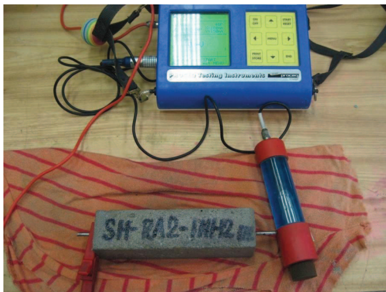
Obr. 23: Souprava pro měření potenciálu poločlánku
