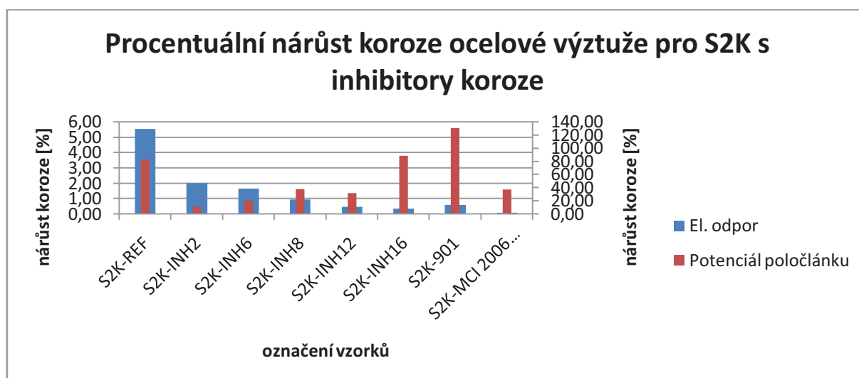
Graf. 25: Procentuální nárůst koroze ocelové výztuže pro stěrku S2K s inhibitory koroze po 7 měsících zatěžování.
