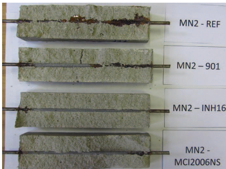
Obr. 32: Koroze ocelové výztuže pro SH - MN2 s inhibitorem koroze INH16 a komerčními inhibitory koroze MCI 2006 NS a 901, po 7 měsících v 3% roztoku NaCl.
