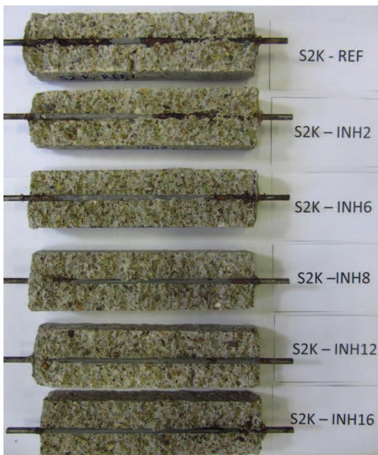
Obr. 33: Koroze ocelové výztuže v betonových vzorcích opatřených stěrkou S2K s inhibitorem koroze INH2 -16, po 7 měsících v 3% roztoku NaCl.
