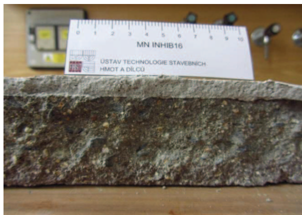
Obr. 16: Vzorek s obsahem dansylchloridu pro stanovení přítomnosti inhibitoru koroze INH16
