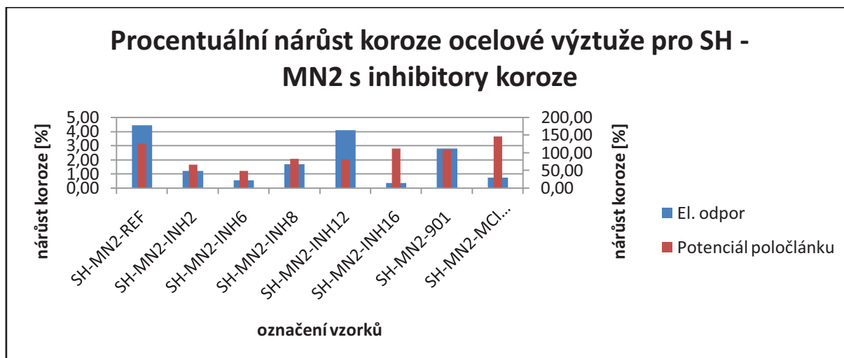
Graf. 20: Procentuální nárůst koroze ocelové výztuže pro správkovou hmotu MN2 s inhibitory koroze po 7 měsících zatěžování.
