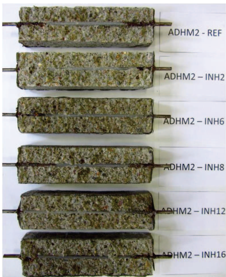
Obr. 25: Koroze ocelové výztuže v betonových vzorcích opatřených adhezním můstkem ADHM2 s inhibitorem koroze INH2 -16, po 7 měsících v 3% roztoku NaCl.
