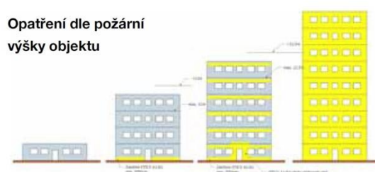
Obrázek 12.1 – Opatření dle požární výšky objektu
