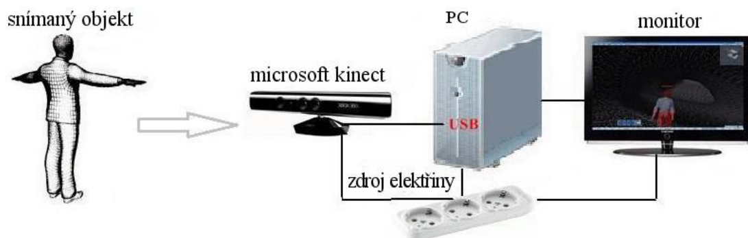
Obr. 7 Schéma propojení Jack – Kinect [vlastní zpracování]
