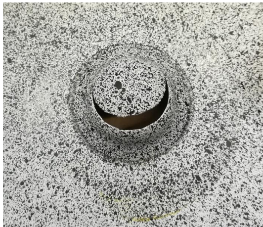
Obr. 48: Obrázek zaměřený na vzorek po měření – s rastrem
