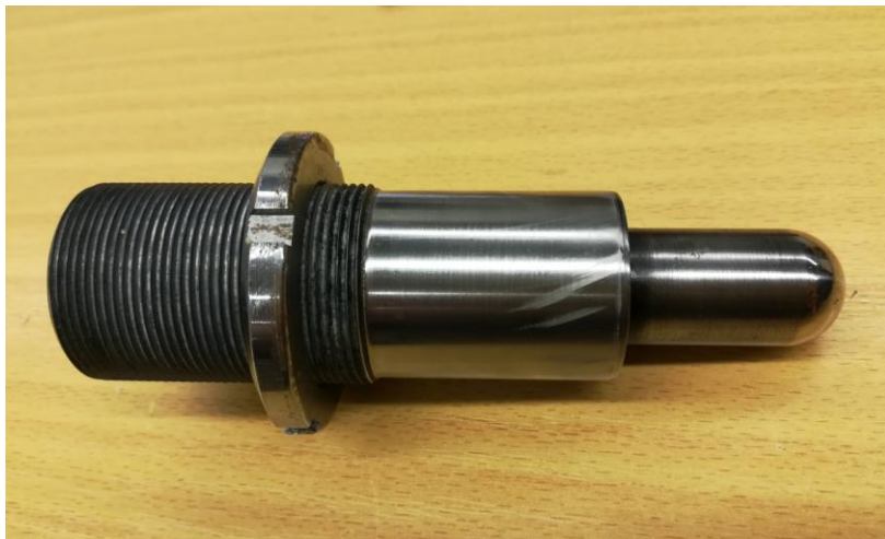
Obr. 35: Obrázek razníku s kulovým zakončením
