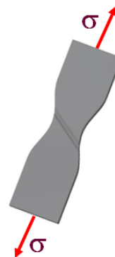
Obr. 8: Krček na zkušební tyčce tahové zkoušky. [6]
