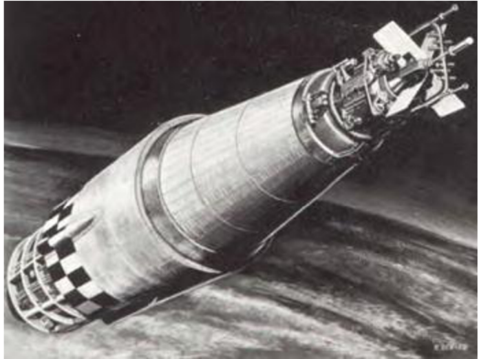
Obr. 9 Reaktor SNAP-10A , pripevnený na nosnej rakete Agena[13]
