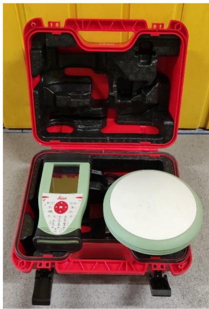
Obrázek 1.2: GNSS sestava s kontrolerem (vlastní)
