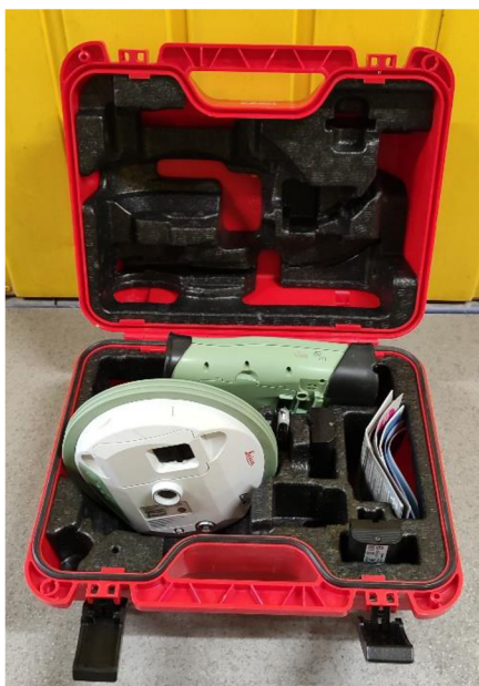
Obrázek 1.3: GNSS sestava s kontrolerem (vlastní)
