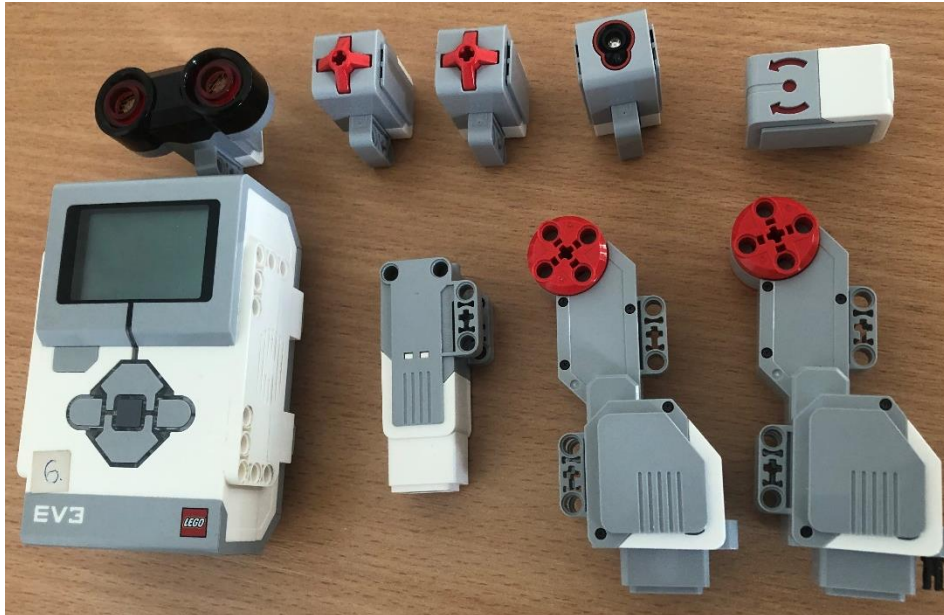
Obrázek 1 Z levého horního rohu: ultrazvukový, dva dotykové, barevný a gyroskopický senzor Z levého dolního rohu: EV3 Brick, střední motor a dva velké motory
