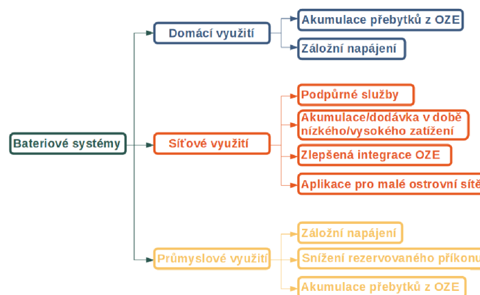
Obrázek 3.1 Využití bateriových systémů
