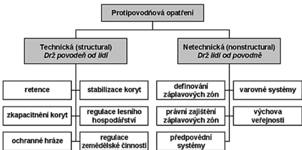
Obr. 3 Klasifikace protipovodňových opatření (zdroj : Čamrová et al. 2006)
