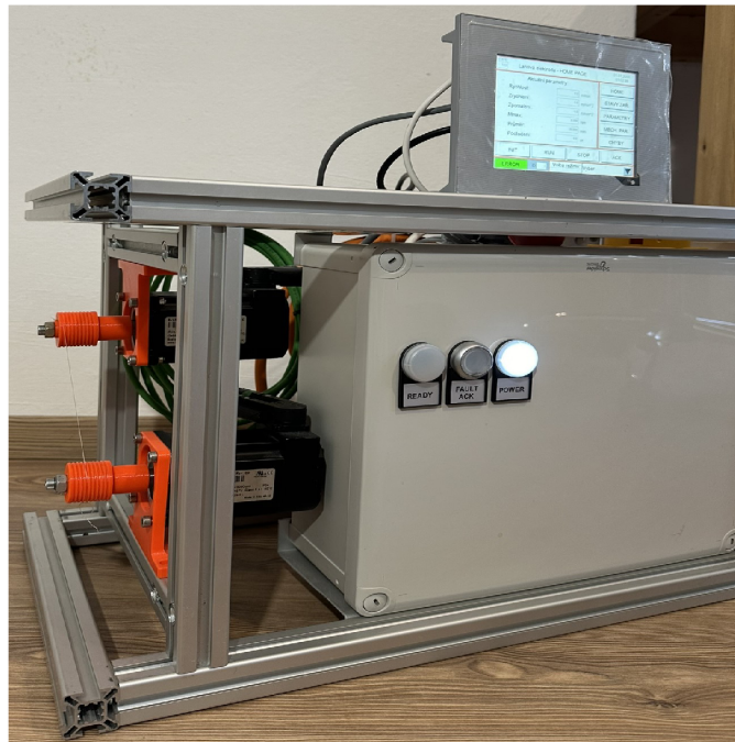
Obrázek 2.2: Laboratorní model linky lanové elektrody
