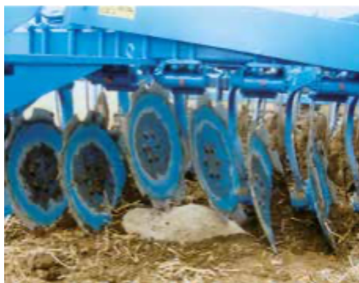
Obrázek 2 - Nezávislé zvednutí disků při kontaktu s překážkou (MALINA, 2008)
