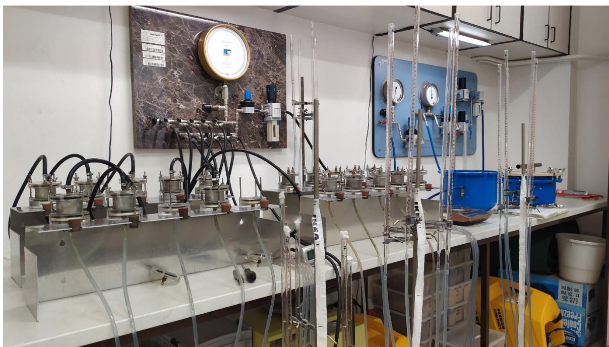
Obrázek 7. Aparatura ke stanovení retenčních čar: Tempské cely nalevo a přetlakový aparát napravo.
