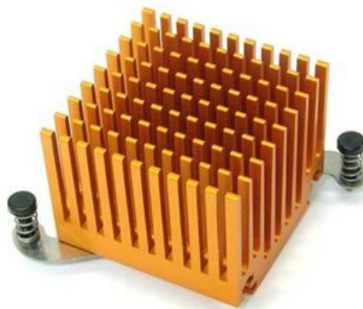
Obrázek č. 5 - Pasivní chladič pro Northbridge [www.nc.cz]
