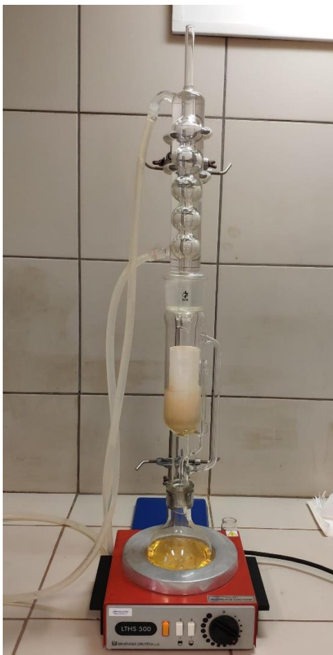
Obrázek 20: Aparatura využitá pro frakcionaci.
