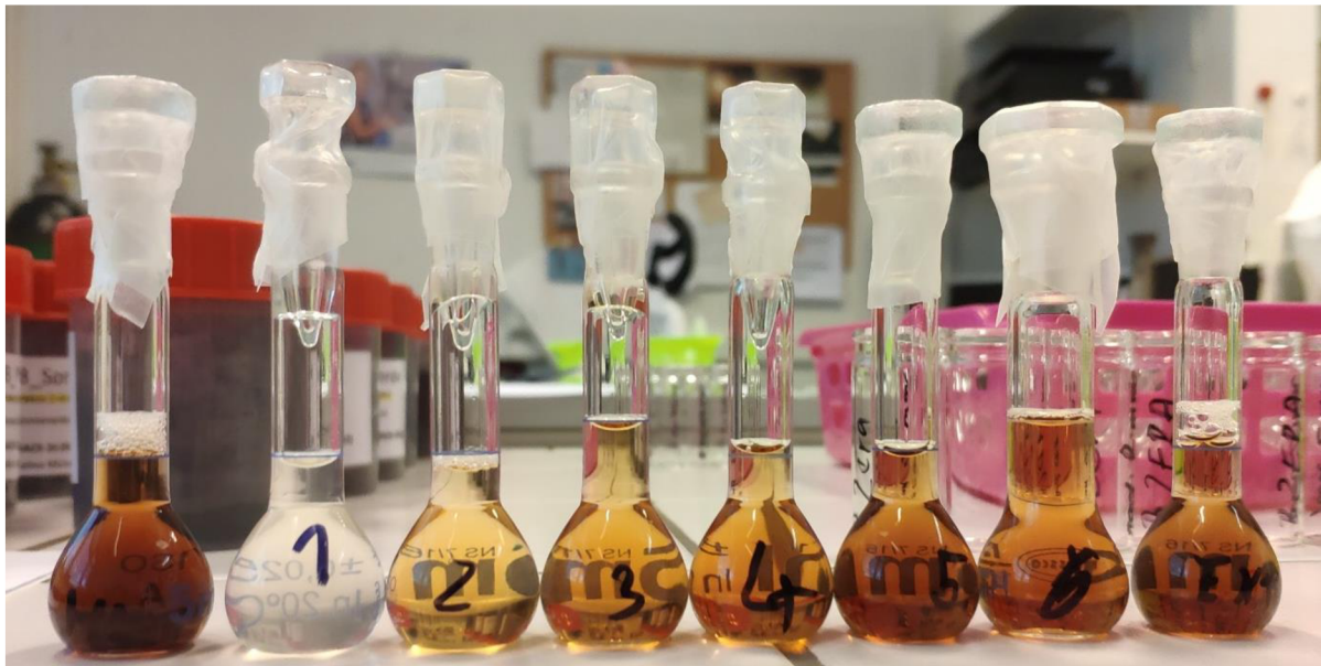
Obrázek 22: Roztoky frakcí před měřením na UV/VIS spektrometru, zleva HK před extrakcí, chloroformová frakce, ethylacetátová frakce, acetonová frakce, acetonitrilová frakce, n-propanolová frakce, methanolová frakce a residuální HK po extrakci.
