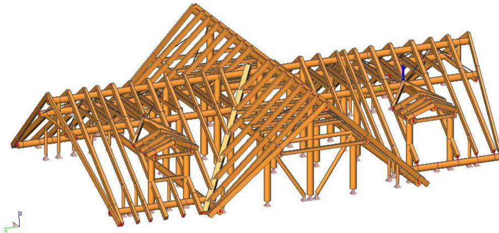
Obr. 4: Konstrukce krovu (výpočtový model)
