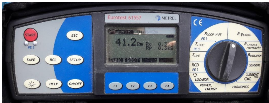
Obr. 6-7 Měření rezistivity půdy přístrojem EUROTEST 61557
