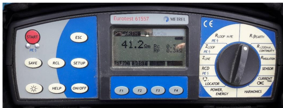
Obr. 6-7 Měření rezistivity půdy přístrojem EUROTEST 61557
