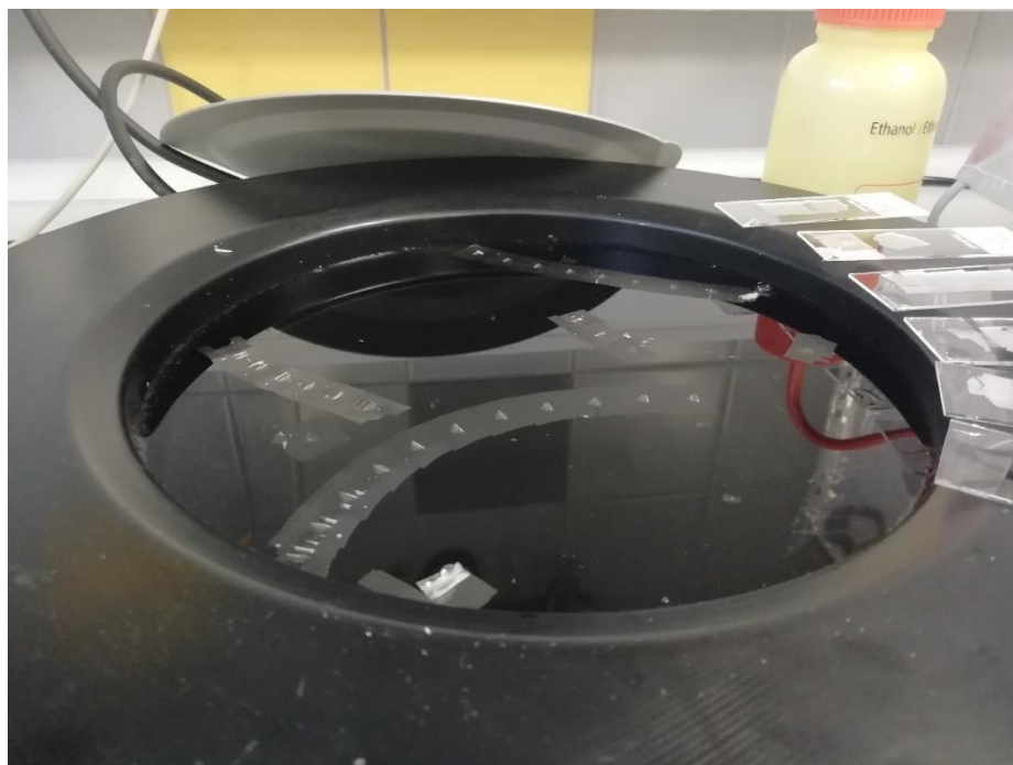
Obr. 21: Napínání sériových řezů vzorku žaber na vodní hladině; foto: J. Kocour.
