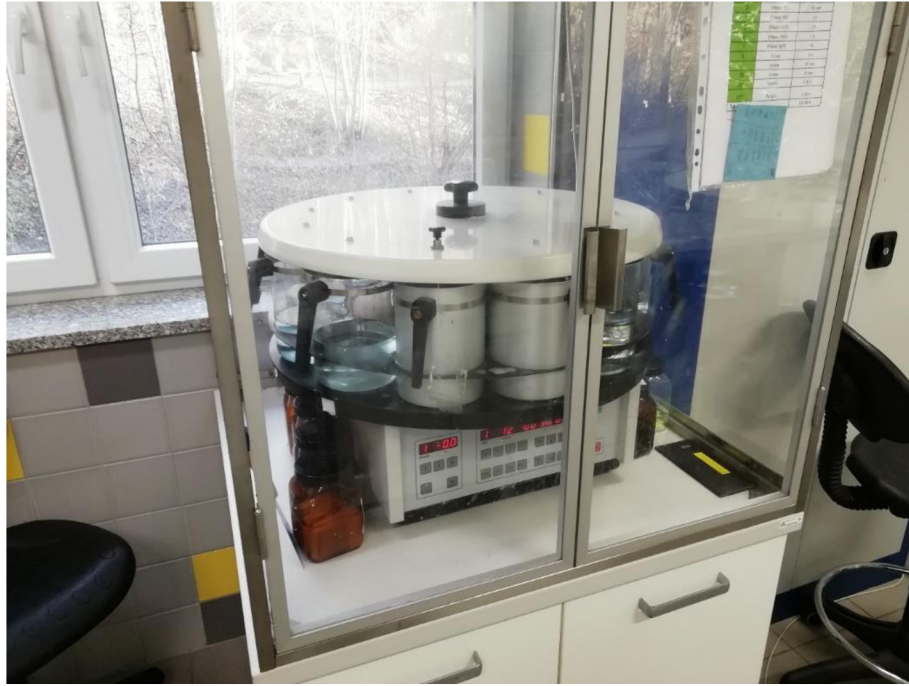
Obr. 13: Prosvcovací automat Histomaster 2052/1.5 (MDS-group, Germany) - pohled zprědu; foto: J. Kocour.
