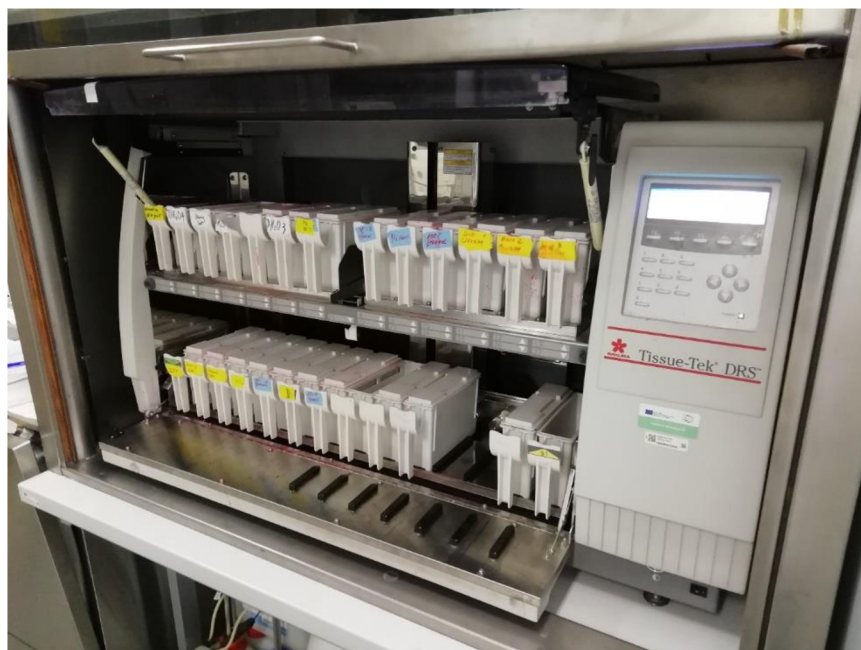
Obr. 22: Barvicí automat Tissue-Tek® DRS™ 2000 používaný v histologické laboratoři Fakulty rybářství a ochrany vod ve Vodňanech; foto: J. Kocour.
