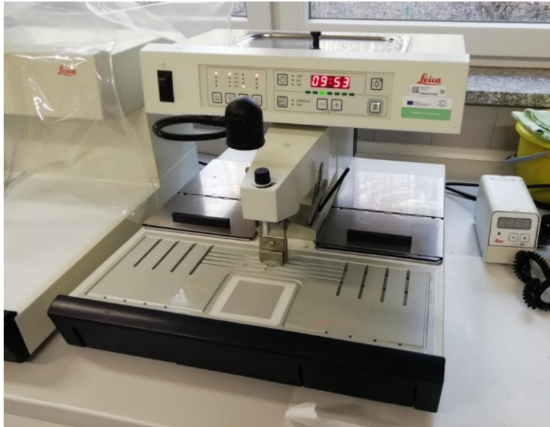
Obr. 15: Parafinový zalévací automat připravený k zalévání tkání; foto: J. Kocour.
