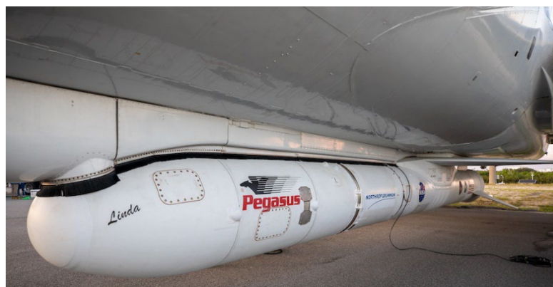
Obrázek 29 Uchycení pod trupem rakety Pegasus [56]
