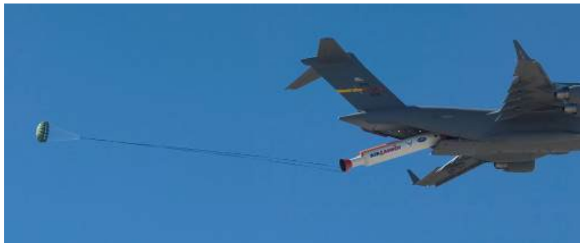
Obrázek 27 Vypouštění z letounu C-17 s využitím padáku [52]
