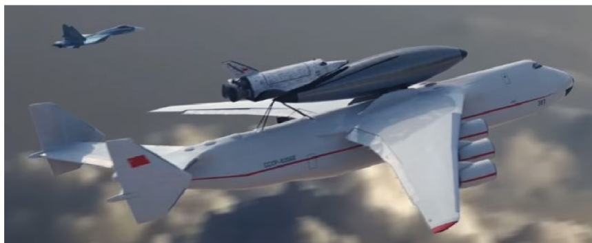
Obrázek 28 Uchycení raketoplánu MAKS na letoun An-224 [53]
