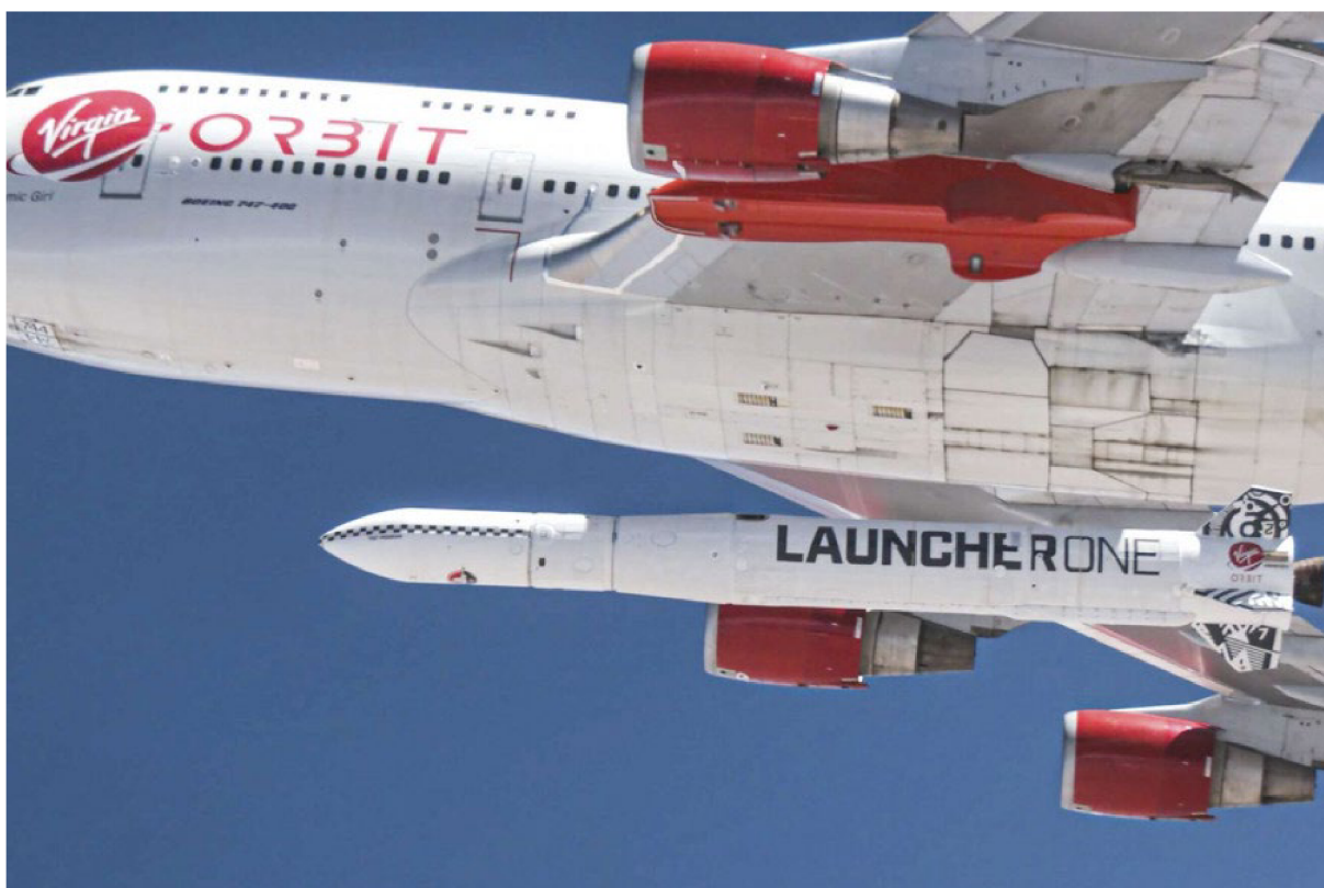
Obrázek 6 Závěsný pylon pod křídlem 747 Cosmic Girl a raketa LauncherOne [12]
