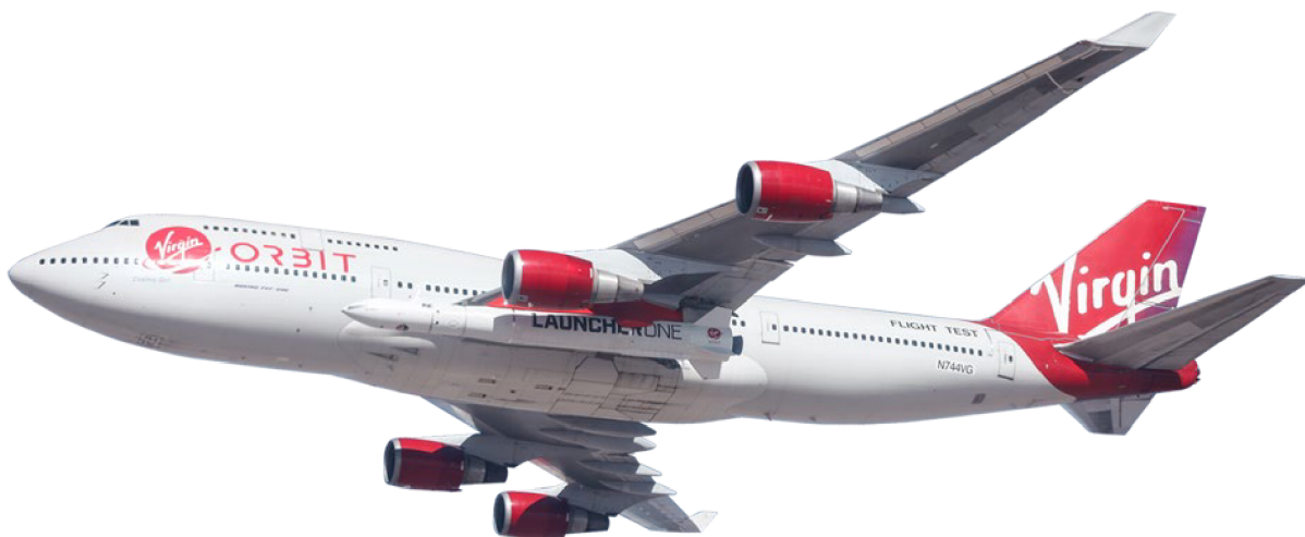
Obrázek 5 Boeing 747-400 Cosmic Girl s raketou LauncherOne v podvěsu [12]
