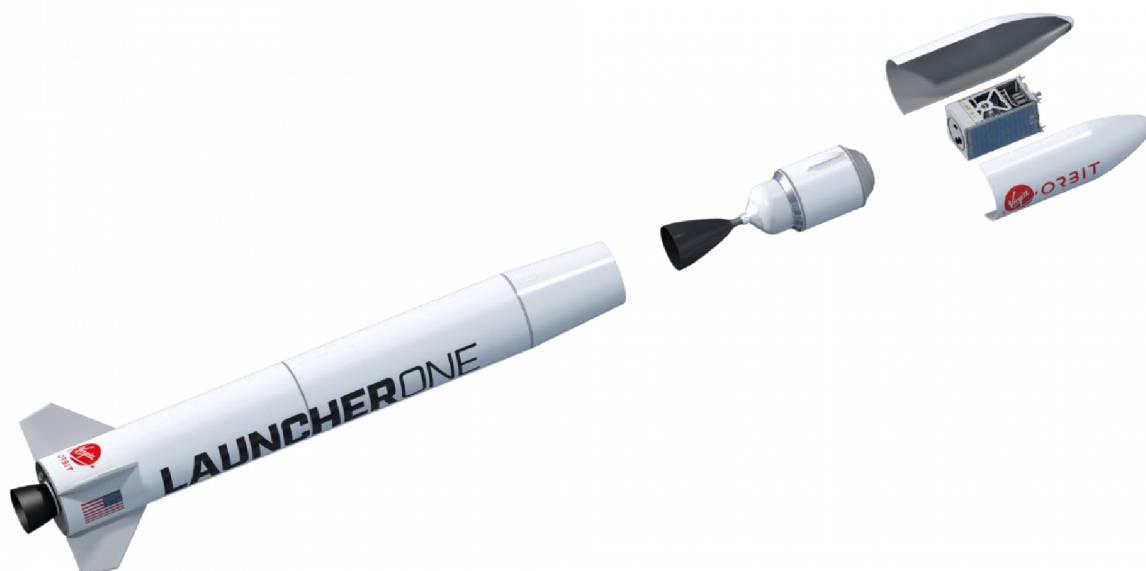
Obrázek 8 Rozložený pohled rakety LauncherOne [12]
