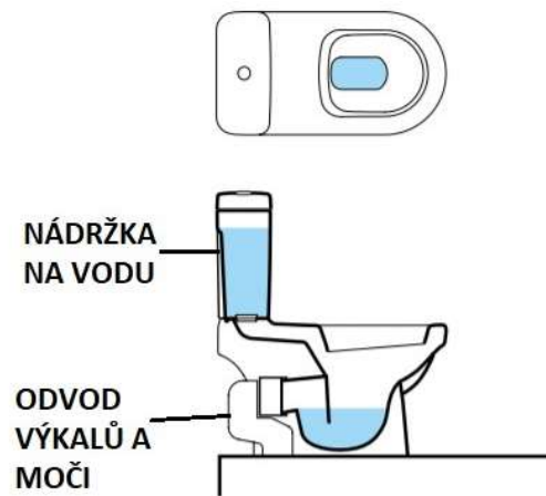
Obrázek č. 16: Schéma splachovací toalety (Zdroj: [18])
