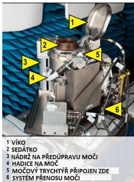
Obrázek č. 20: Schéma toalety UWMS (Zdroj: [67])
