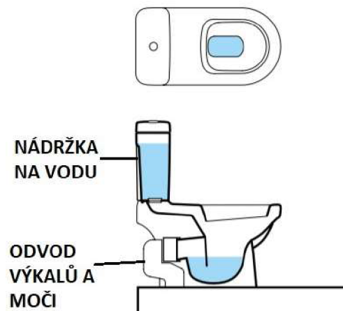
Obrázek č. 16: Schéma splachovací toalety (Zdroj: [18])
