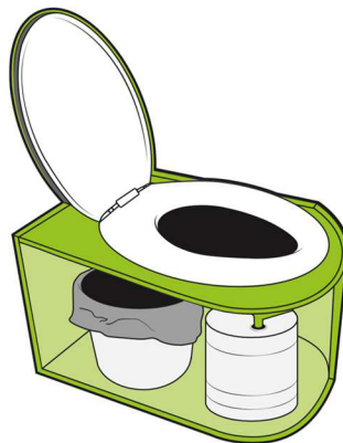
Obrázek č. 9: Schéma toalety na bázi kontejnerů (Zdroj: [36])
