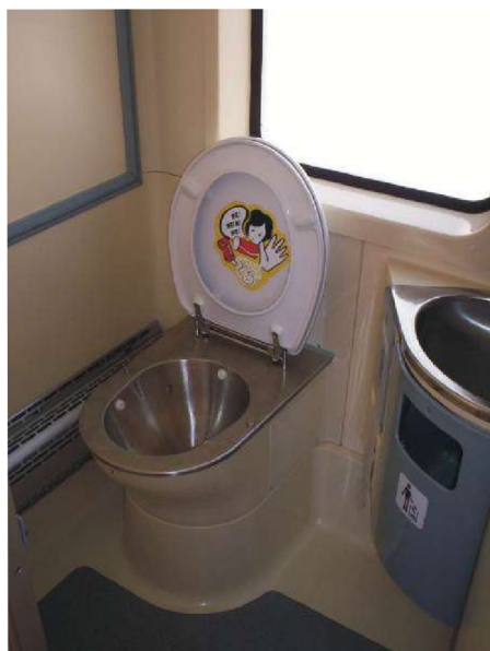
Obrázek č. 19: Vakuová toaleta ve vlaku (Zdroj: [69])
