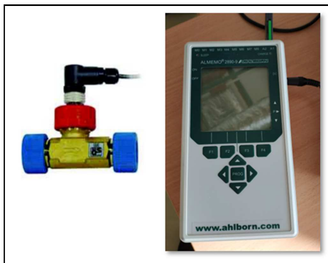
Obr. 14 – Snímač průtoku FV A915 VTHM a měřící ústředna Almemo 2890-9
