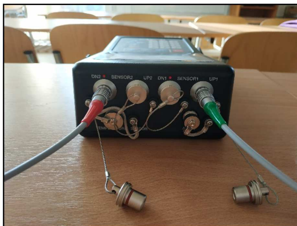
Obr. 16 – Ústředna Keiki s napojením s napojenými kabely
