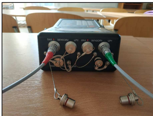
Obr. 16 – Ústředna Keiki s napojením s napojenými kabely
