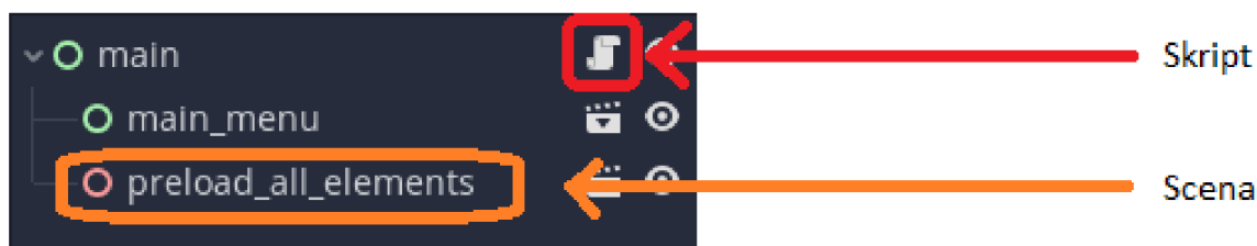
Obrázek 5.2: Main scéna. Na obrázku je vidět, že scéna „main“ je poskládaná z dvou jiných scén, „main_menu“ a „preload_all_elements“, taky má přidáno script. První scéna je 2D scéna typu „GUI“ (má zelenou barvu), druhá je 3D scéna (růžová barva).
