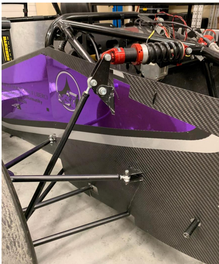
Obrázek 29 Konstrukce předního pushrodu s vahadlem a tlumičem
