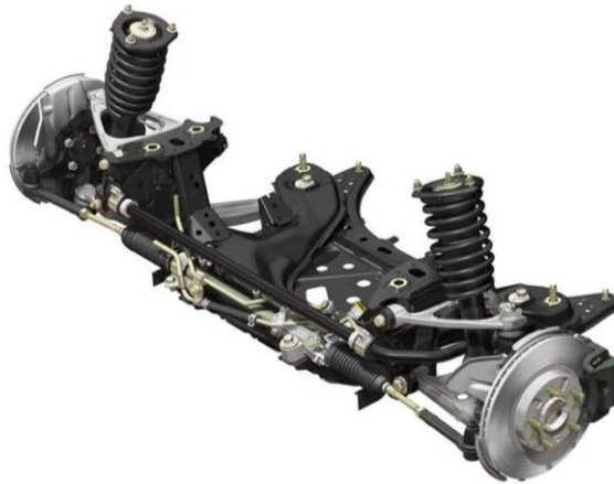
Obrázek 1: Lichoběžníková náprava vozu Mazda MX-5[3]
