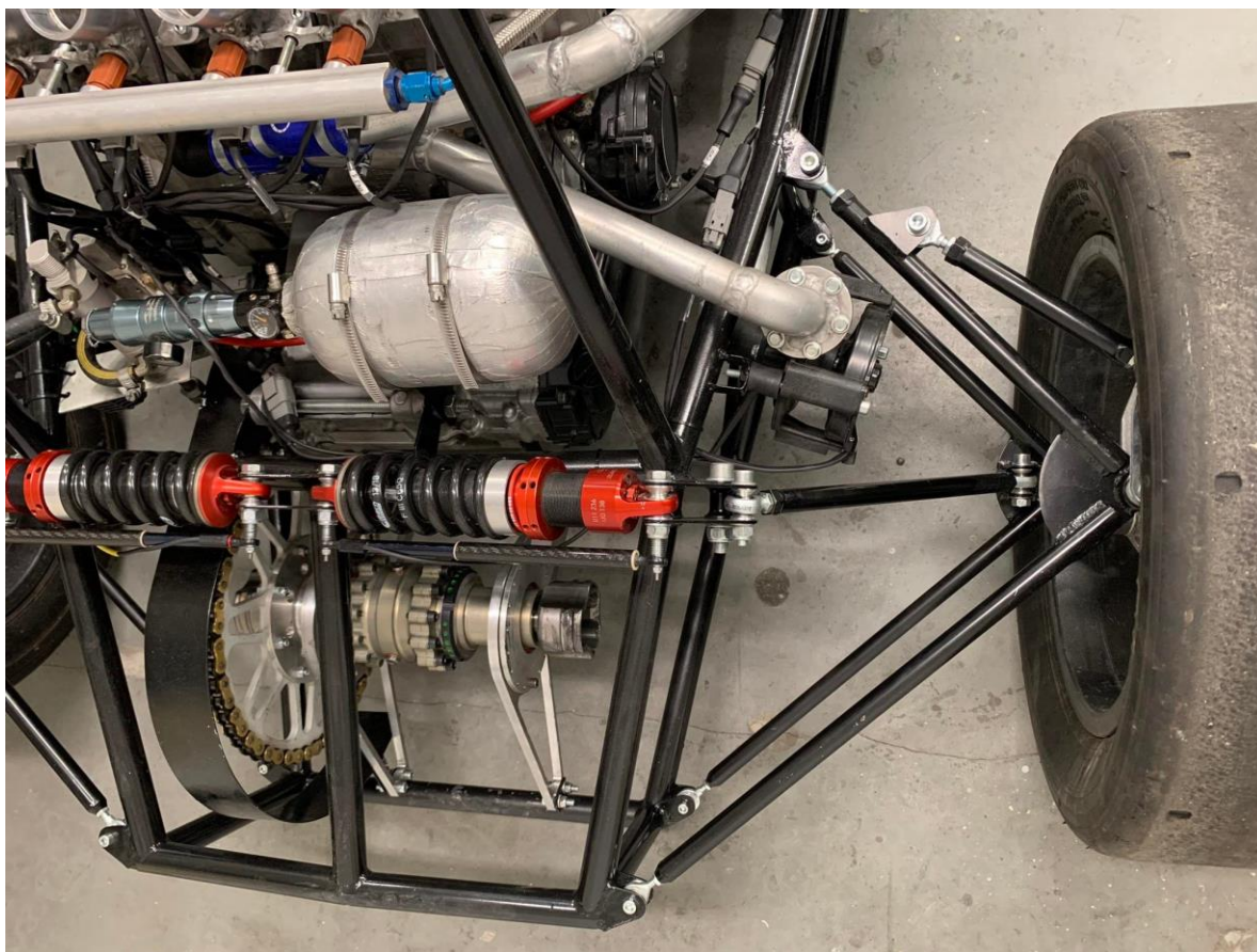
Obrázek 30 Konstrukce odpružení zadní nápravy
