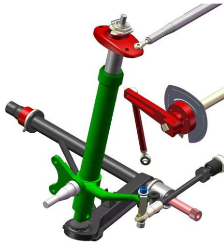
Obrázek 5:Zavěšení Porsche 911 McPherson[12]
