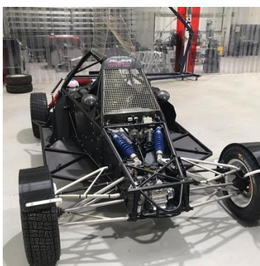
Obrázek 8: Přední lichoběžníková náprava Super buggy od Alfa racing
